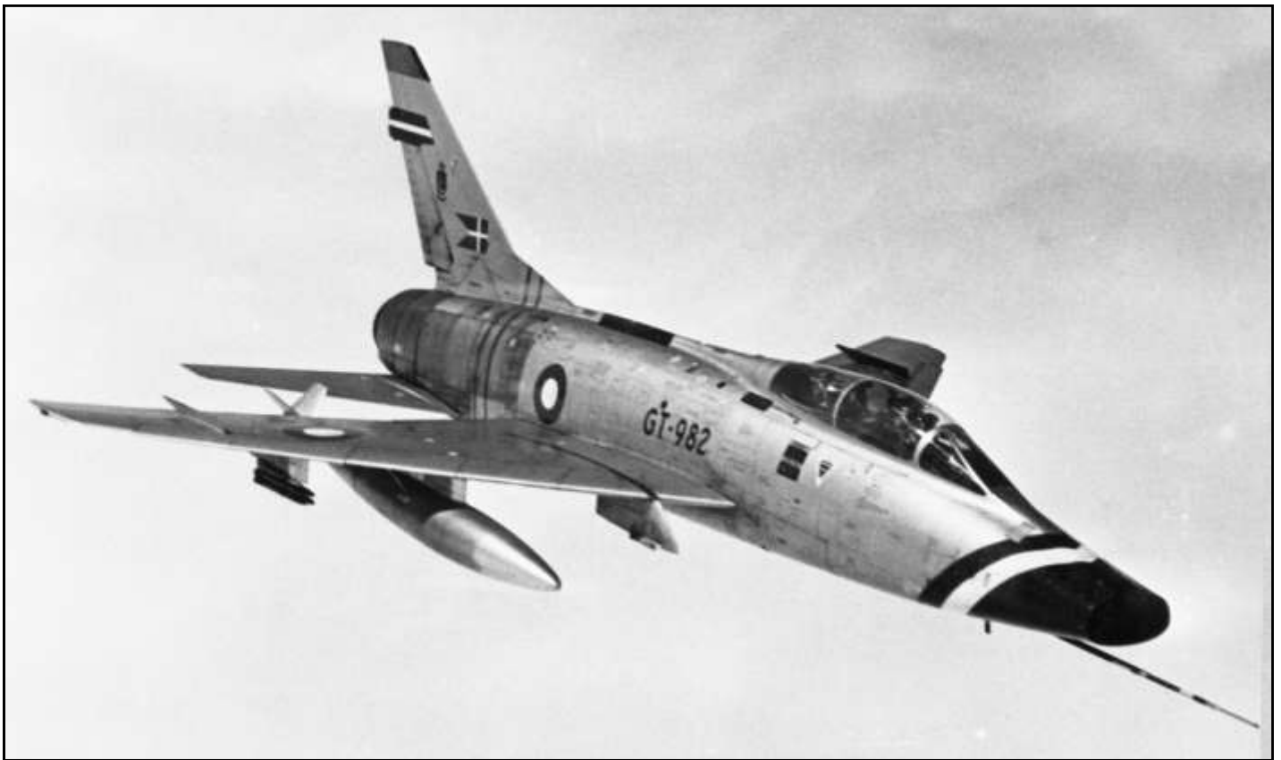
F-100F fra ESK730 med firehuls øvelsesraketstyr på yderpylon.
