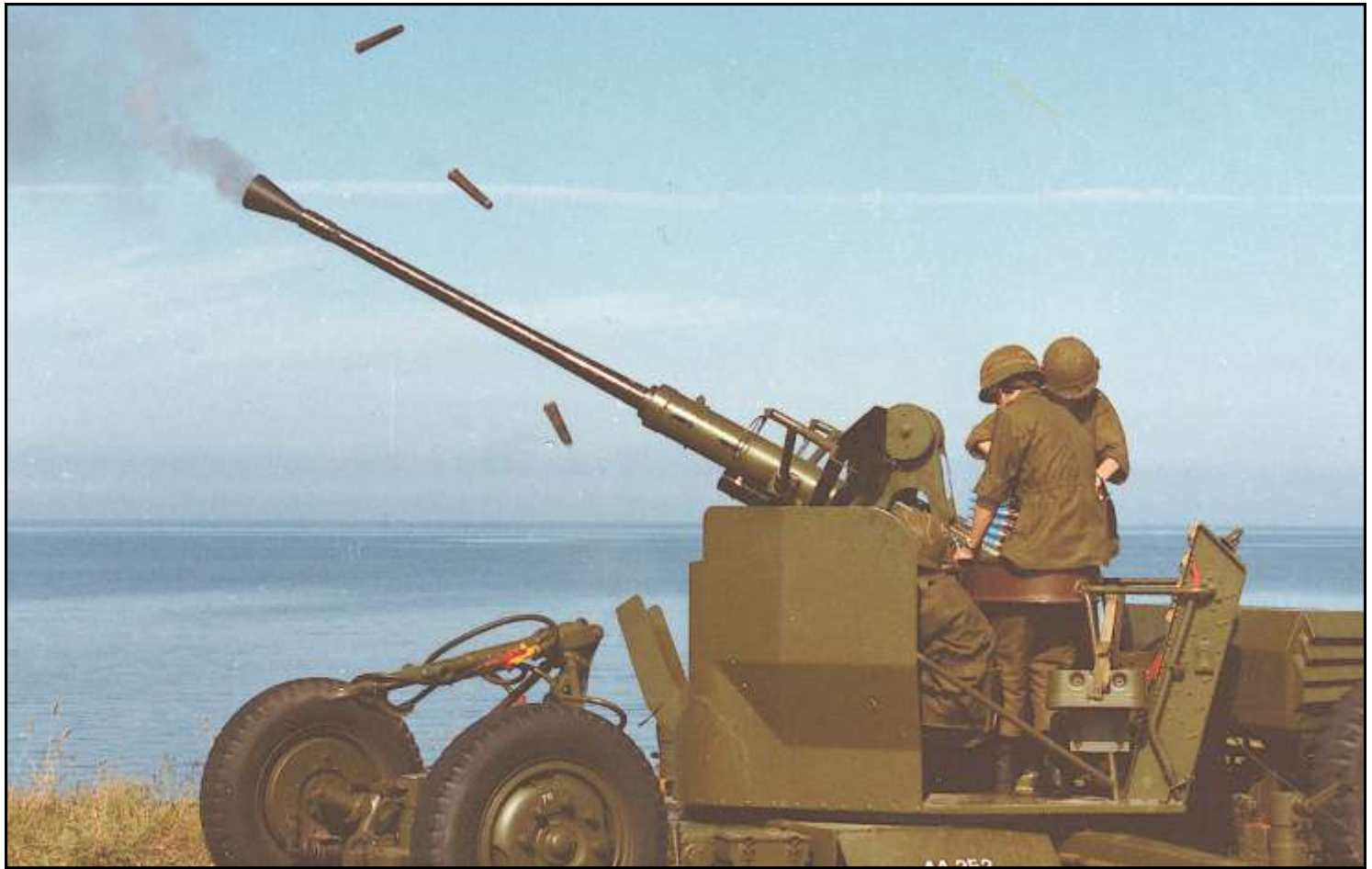
Skarpskydning med L/70 kanon. Bemærk, at hylstrene i luften bliver kastet fremad og til højre.
