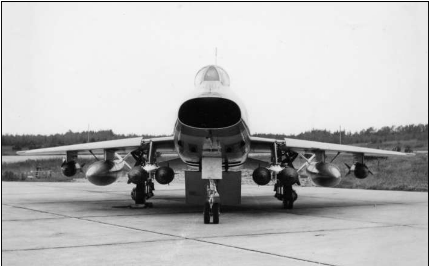
F-100D med triple ejector racks på inderpylons og i alt 6 stk. M117 750 pounds bomber.
